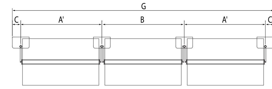
N.B. GLI INTERASSI SONO DIVERSI A SECONDA DEI PALI UTILIZZATI. NOTARE CHE IL CASO CON NR. 3 FLEXY RICHIEDE UN INTERASSE B PERCHÈ IL FLEXY CENTRALE È SORRETTO DA NR. 2 PALI DOPPI MENTRE I FLEXY AI LATI SONO SORRETTI DA NR. 1 PALO LATERALE.
