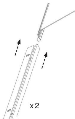
n°2 staffe per fissare le tende laterali in acrilico, in posizione raccolta e n° 2 profili per il fissaggio delle tende a muro, ogni profilo è predisposto con n°3 fori e la bulloneria per il fissaggio a muro è esclusa. Disponibili nei colori della struttura.
