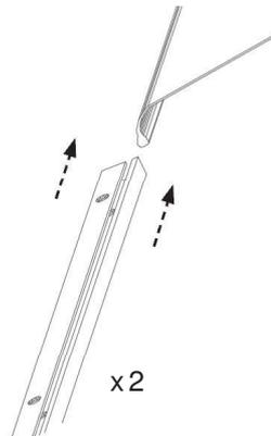
Kit composto da n°2 staffe per fissare le tende laterali in acrilico, in posizione raccolta e n°2 profili per il fissaggio delle tende a muro, ogni profilo è predisposto con n°3 fori e la bulloneria per il fissaggio a muro è esclusa. Disponibili nei colori della struttura.
